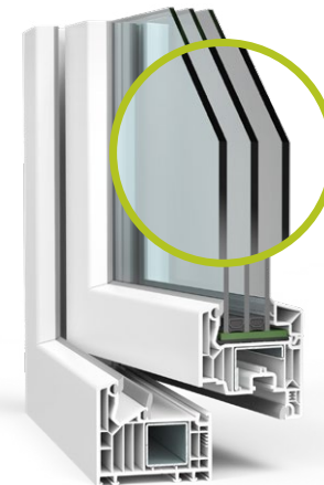
Die Kombination macht's: Modernes 3-Scheiben-Wärmeschutzglas z. B. mit einem U_g -Wert von 0,6 W/m^2K und hochwärmedämmende Profilrahmen mit einem U_f -Wert von 1,0 W/m^2K sorgen für einen hervorragenden U_w -Wert für das gesamte Fenster von 0,81 W/m^2K .
